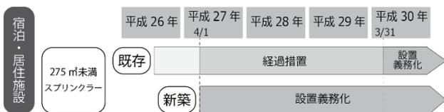
図 1 スプリンクラーにおける既存の防火対象物の経過措置
