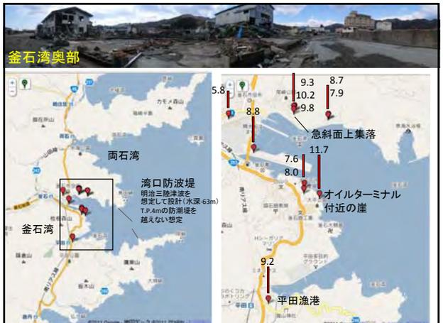
釜石湾平田漁港付近 浸水高9.2m 漁港近くは壊滅状態 すぐ近くに高台が迫り、ここでは被害小
