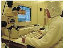
原子間力顕微鏡 (AFM)・磁気力顕微鏡 (MFM)
