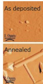
図：テラヘルツ領域の誘電分散とAFMイメージ。膜質の違いが誘電率に反映されている。
