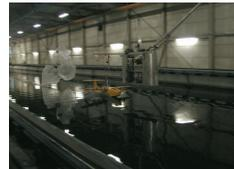
飛行艇模型の離着水実験
