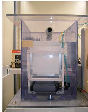
図2 PTFE平膜を適用した膜分離活性汚泥法の反応槽。
