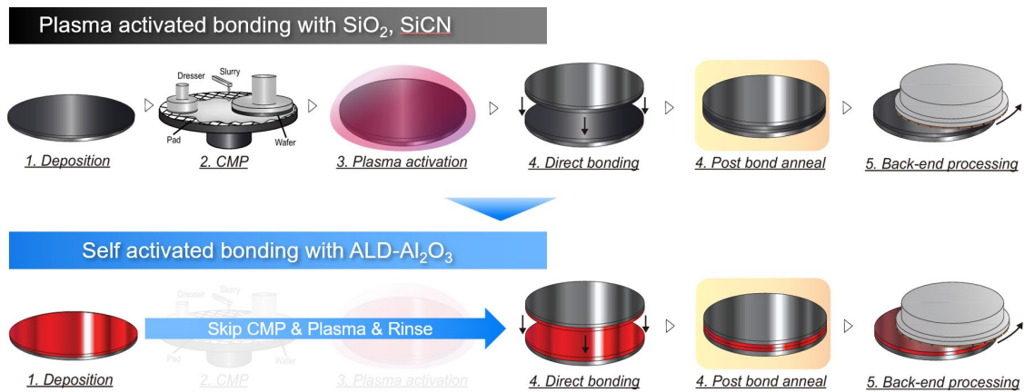
図 2 前処理工程（CMP/Plasma/Rinse）を省略した自己活性化接合スキーム
