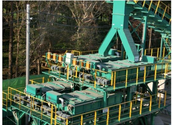
写真5 炭酸ガスを曝すリアクター
