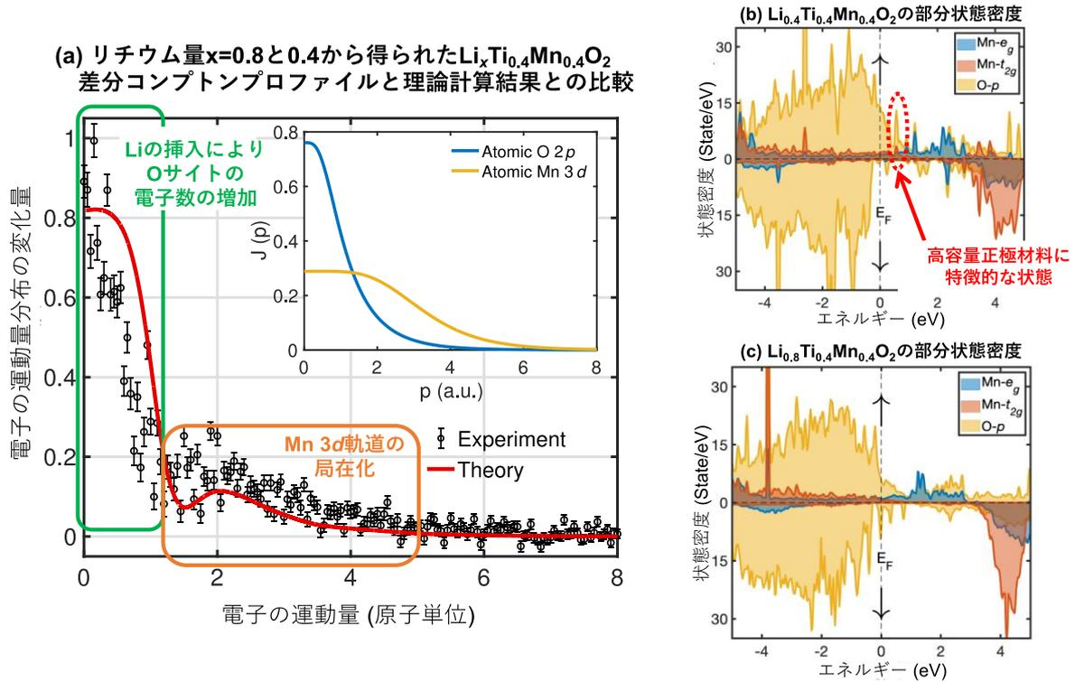
(a) リチウム量  $x=0.8$  と  $x=0.4$  の  $\text{Li}_x\text{Ti}_{0.4}\text{Mn}_{0.4}\text{O}_2$  から得られた差分コンプトンプロファイル。図の赤線は理論計算から得られた差分コンプトンプロファイル。挿絵は原子モデル計算から得られた Mn 3d 軌道と O 2p 軌道のコンプトンプロファイル。(b)  $\text{Li}_{0.4}\text{Ti}_{0.4}\text{Mn}_{0.4}\text{O}_2$ の部分状態密度(c)  $\text{Li}_{0.8}\text{Ti}_{0.4}\text{Mn}_{0.4}\text{O}_2$ の部分状態密度
