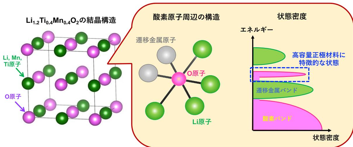
Li原子と遷移金属原子（Mn原子とTi原子）が不規則に配列したLi<sub>1.2</sub>Ti<sub>0.4</sub>Mn<sub>0.4</sub>O<sub>2</sub>の構造と本物質の酸素原子周囲の構造、ならびに分子軌道モデルから予想される状態密度の模式図。（結晶構造の作図はVESTAを利用しました）
