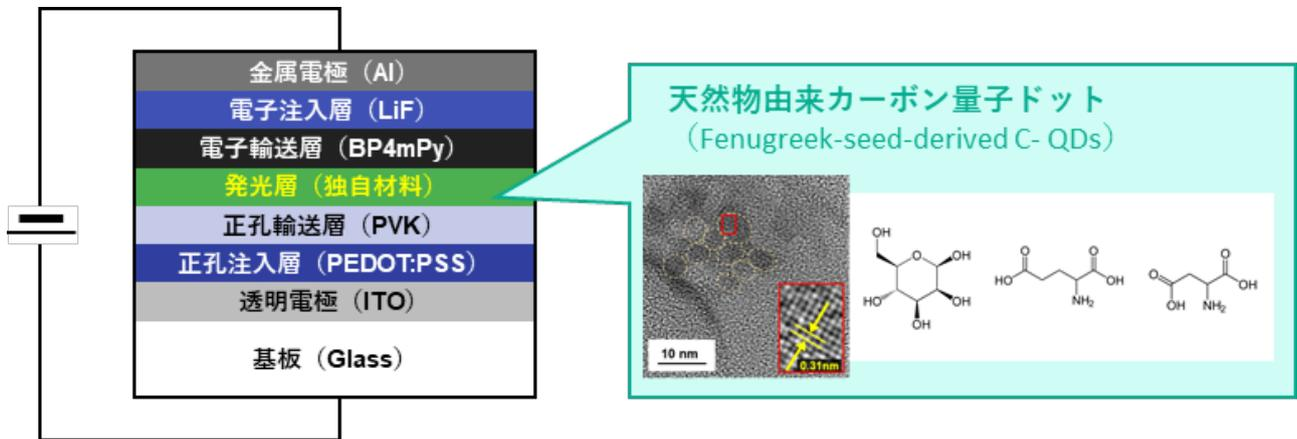
図 2 EL デバイスの構成要素 デバイス断面図/発光層の構成成分（TEM 観察写真）
