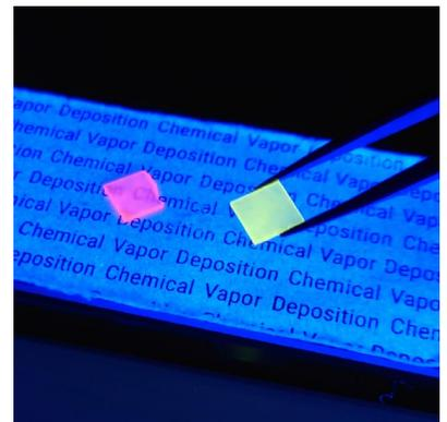
現在半導体や車載バッテリーの検査工程向けの高分解能 X 線 CT 撮像装置の需要が高まっています。本技術は、そのコア材料となるマイクロメートル厚シンチレーターの極めて高速な製造法として活用が期待されます。
