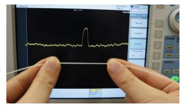
しています。特に注力しているのは、光ファイバに沿った任意の位置で伸びや温度、反射率などの計測ができる「分布型」の光ファイバセンサです。これまでに、連続光の相関制御という従来とは全く異なる原理に基づくシステム「光相関領域反射計」を開発し、世界最高の動作速度や空間分解能を達成しました。
